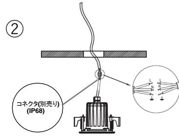
天井裏のケーブルと照明本体のケーブルを接続し、結線部分に防水処理を施す。
