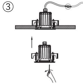
照明本体を穴の中に入れ、ドライバーでネジを回して天井に取り付ける。
