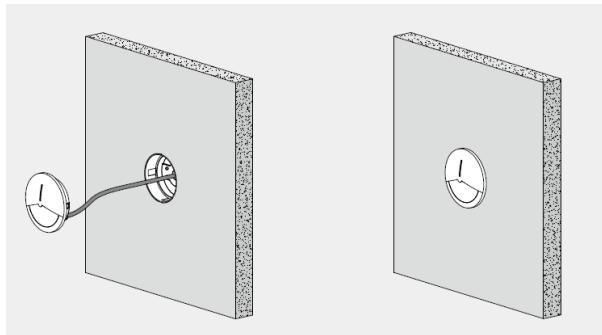
①取り付け位置に埋込ボックスに合う穴を開け、ボックスを穴に差し込んでください。
